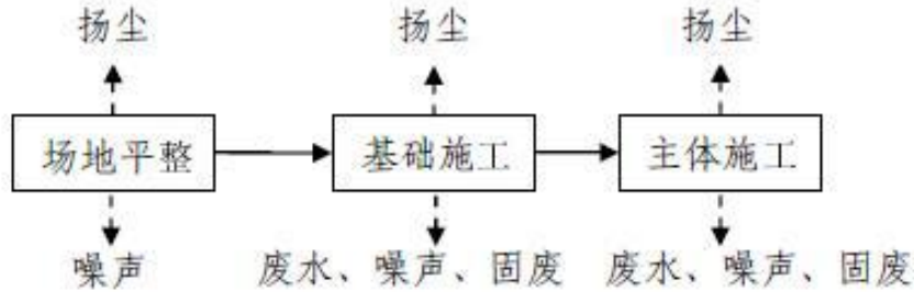
图 5-1 施工期工艺流程及产污节点图
