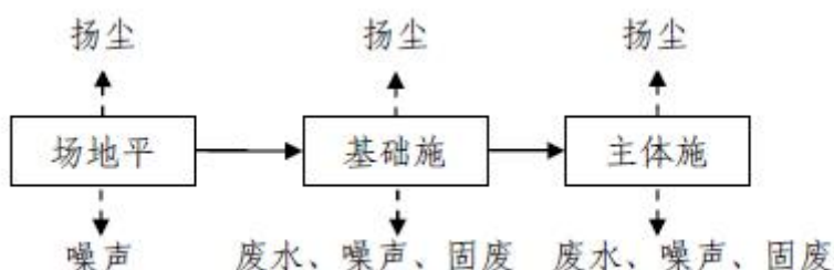
图 5-1 施工期工艺流程及产污节点图
