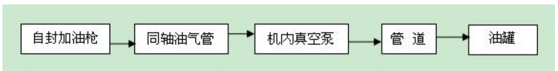
图 5-4 二次（加油）油气回收流程图
