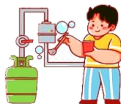
定期用肥皂水检查管线
